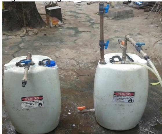
Figura 1 - Biodigestor montado estágio final
