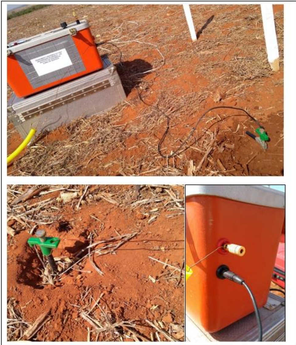
Figura 1 - Estação transmissora TX 27 e detalhes da conexão da antena com o equipamento e com os pontos de aterramento.
