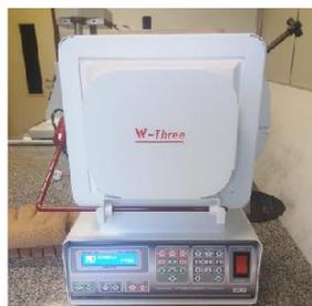
Forno mufla modelo W-Three da EDG usado para fusão das amostras
